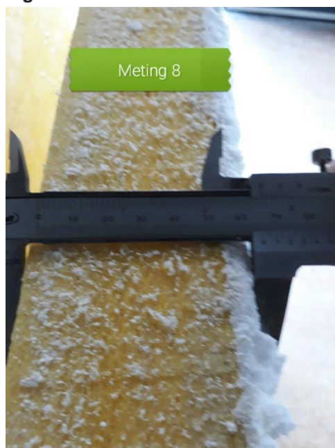
Opbouw: Power Acoustics 5 mm Sonaboard dikte 60 mm
