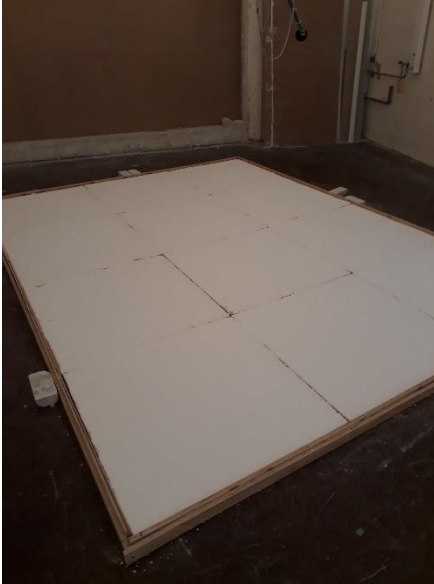
Meetopstelling in nagalmkamer
