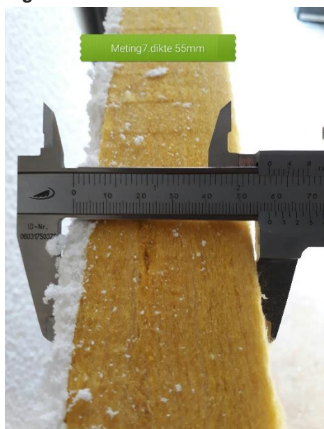
Opbouw: Power Acoustics 5 mm Sonaboard dikte 50 mm
